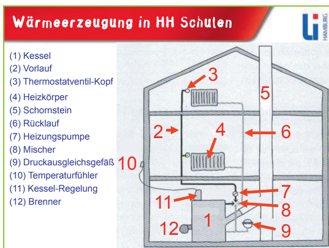
Abb. 7.02 Schema einer Heizungsanlage mit Gaskessel (Quelle: LI, Hamburg in Anlehnung an Graf/Koch/Schulz 2 )
